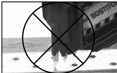
Colocación incorrecta del clavo
