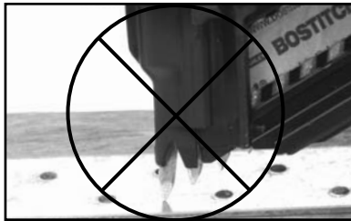
Mauvais placement du clou
